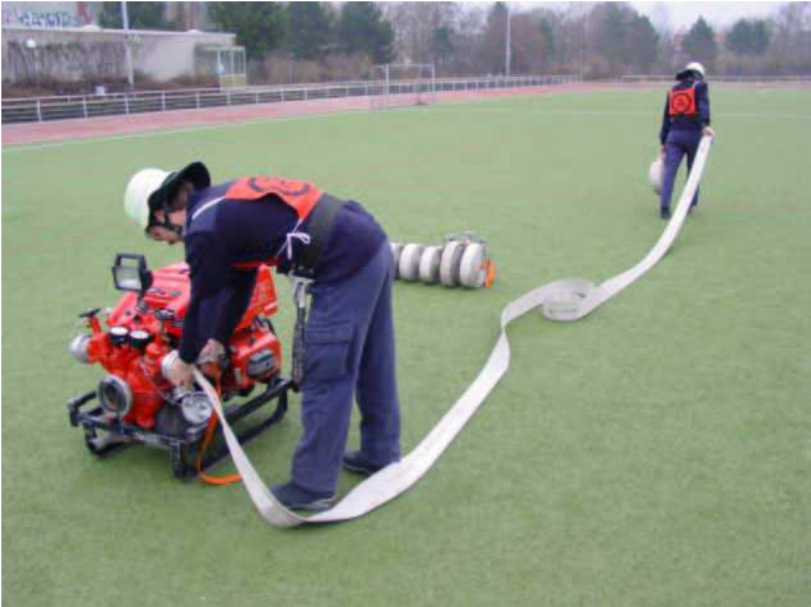
Bild 9 : Auslegen des B-Schlauches
